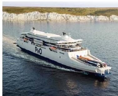
Antriebseinheiten mit einer Leistung von je 7,5 MW ausgestattet. Die Inbetriebnahme ist für 2023 geplant.
