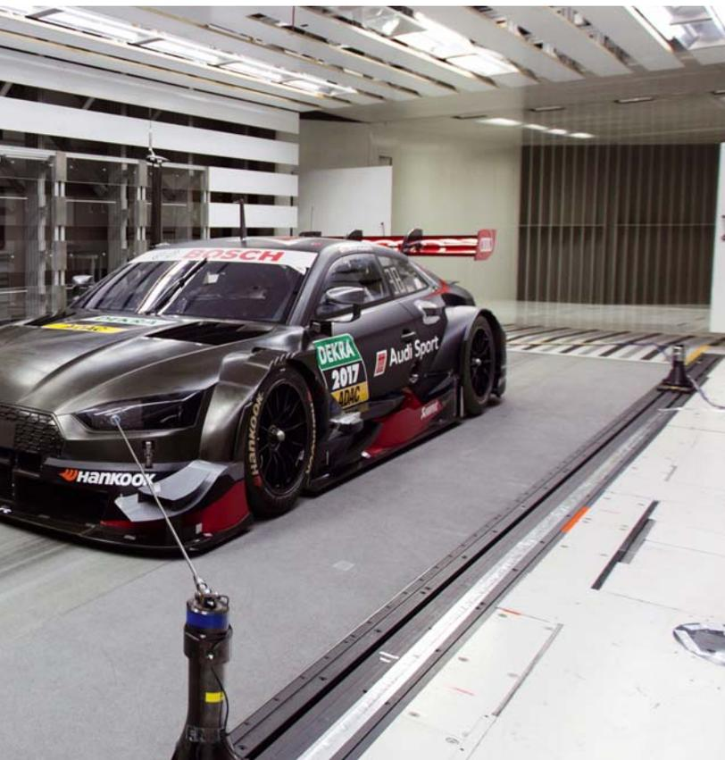
«Der Frequenzumrichter, der den Elektromotor für diese «rollende Strasse» angetrieben hatte, kam ans Ende seiner technischen Lebenserwartung», erklärt Thomas Furrer, verantwortlich für Betrieb, Unterhalt und Weiterentwicklung des Windkanals bei der Sauber Aerodynamik AG. Es wurde zunehmend schwieriger, den Service zu leisten und Ersatzteile zu finden.
