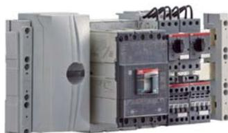
Das neue 60-mm-Sammelschiensystem Unifix AD ermöglicht eine einfache, sichere und schnelle Montage verschiedener Komponenten durch einfaches Aufstecken. Im Vergleich zu einer Standardlösung spart der Unifix AD dadurch bis zu 60 % Zeit bei der Montage.
