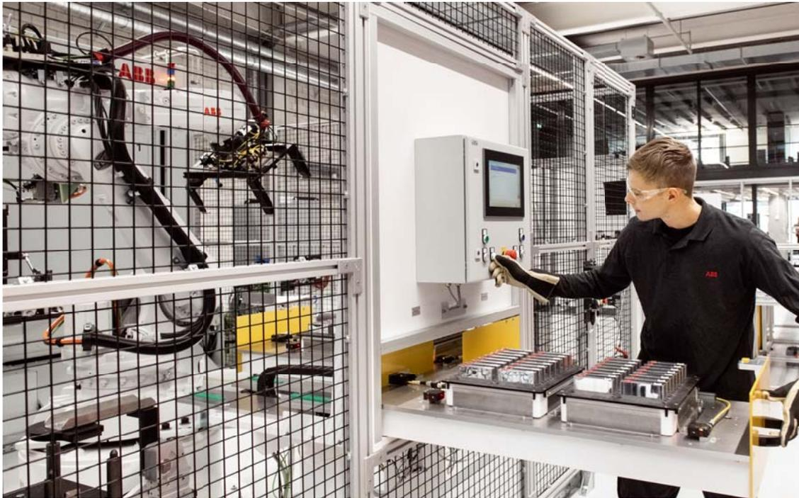
Die Roboterzelle für das Verschweissen der Batteriezellen zu Modulen ist das Herzstück der neuen Produktionsanlage in Baden.
