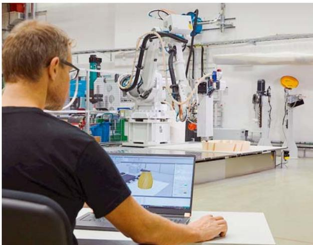
Die neue 3-D-Druckfunktion unterstützt eine Vielzahl von Prozessen, etwa Drucken mit Granulat oder Beton, und eignet sich ideal für das Drucken geringer Volumen.
