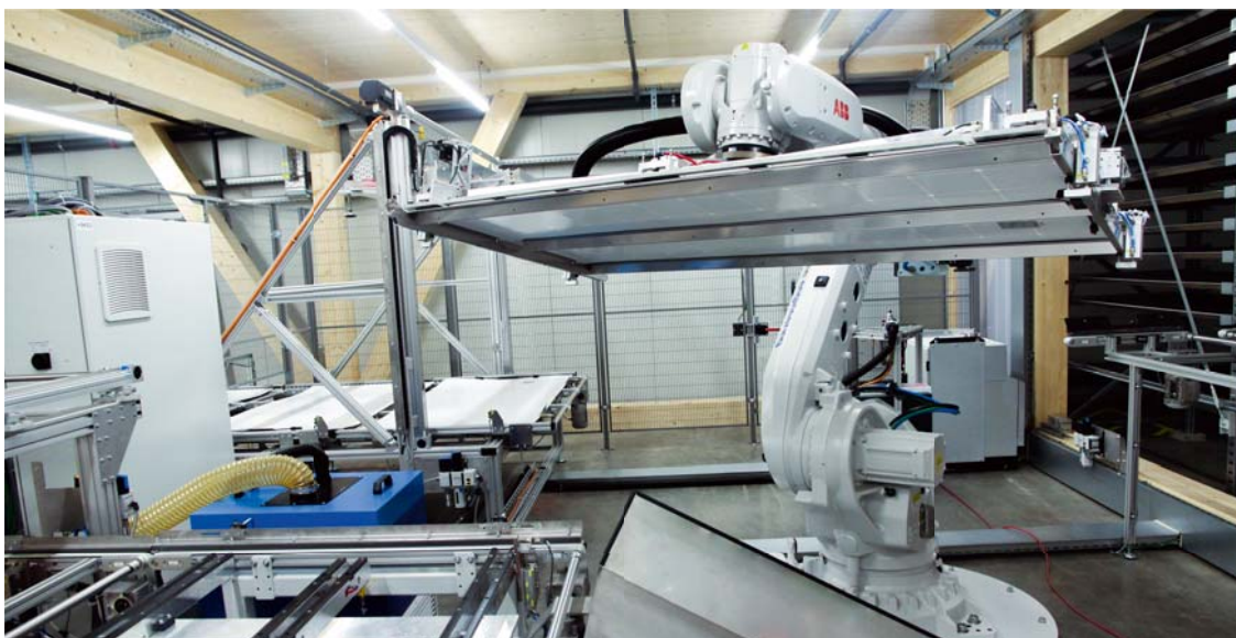
— Der Industrieroboter IRB 6700 von ABB verklebt die Photovoltaikmodule vollautomatisch mit den Chromstahlrahmen.
