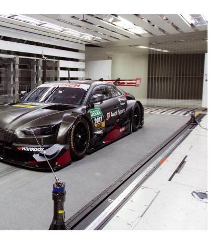
«Der Frequenzumrichter, der den Elektromotor für diese (rollende Strasse) angetrieben hatte, kam ans Ende seiner technischen Lebenserwartung», erklärt Thomas Furrer, verantwortlich für Betrieb, Unterhalt und Weiterentwicklung des Windkanals bei der Sauber Aerodynamik AG. Es wurde zunehmend schwieriger, den Service zu leisten und Ersatzteile zu finden.
