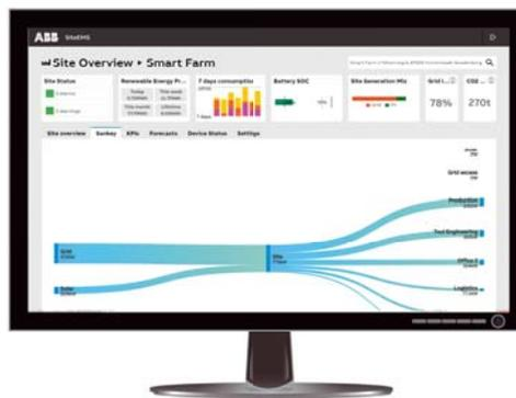
Le système de gestion de l'énergie basé sur ABB Ability Energy Optimization surveille, pilote et optimise l'ensemble des producteurs et consommateurs électriques. La solution calcule l'utilisation optimale et la fourniture d'électricité par le réseau de manière à remplir toutes les conditions techniques et économiques et à minimiser le coût total et les émissions totales.
