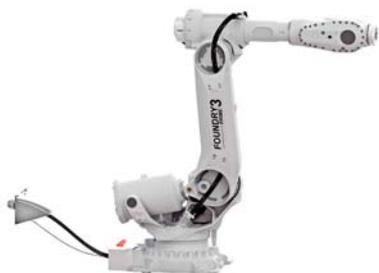
L'IRB 6790 est conçu pour les applications de nettoyage à jet d'eau haute pression dans des environnements où l'humidité de l'air peut atteindre un taux de 100%.
