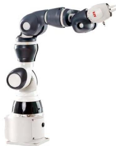
Le Single-arm YuMi est à ce jour le robot collaboratif le plus agile et le plus compact d'ABB. Il s'intègre parfaitement aux chaînes de production existantes et travaille en toute sécurité aux côtés des individus. Le Single-arm YuMi se distingue par un faible encombrement et peut être monté sur le sol, sur la table, au mur ou au plafond. Grâce à la programmation Lead Through intuitive et conviviale, les collaborateurs peuvent installer et utiliser le robot sans formation spéciale.
