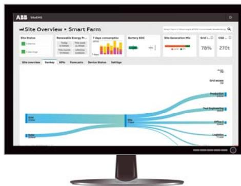
Das Energiemanagementsystem auf der Basis von ABB Ability Energy Optimization überwacht, steuert und optimiert alle elektrischen Erzeuger und Verbraucher. Die Lösung berechnet den optimalen Einsatz und Netzbezug, sodass alle technischen und wirtschaftlichen Randbedingungen erfüllt und die Gesamtkosten oder die Gesamtemissionen minimal sind.
