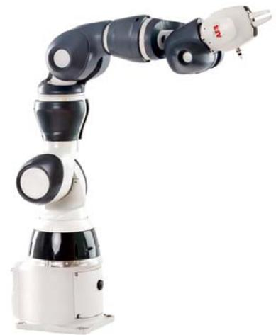
Single-arm YuMi ist der bisher agilste und kompakteste kollaborative Roboter von ABB. Er lässt sich problemlos in vorhandene Produktionslinien integrieren und arbeitet sicher Seite an Seite mit Menschen zusammen. Er zeichnet sich durch geringen Platzbedarf aus und kann auf dem Boden, auf dem Tisch, an der Wand oder an der Decke montiert werden. Dank der intuitiven und benutzerfreundlichen Lead-Through-Programmierung können Mitarbeiter den Roboter ohne spezielle Schulung einrichten und bedienen.
