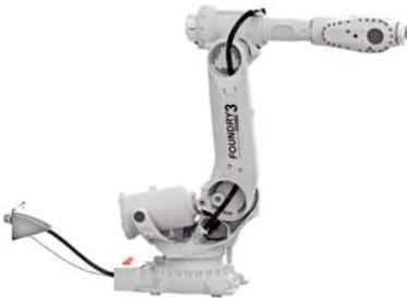
Der IRB 6790 ist für Hochdruck-Wasserstrahl-Reinigungsanwendungen in Umgebungen mit bis zu 100 % Luftfeuchtigkeit ausgelegt.
