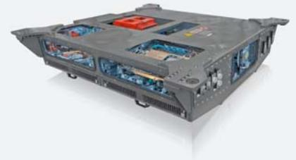
Der BORDLINE CC400 ist ein Kompaktkonverter, der Antriebs- und Bordnetzumrichter in sich vereint. Er wurde für eine grosse Bandbreite von Stadt- und Strassenbahnen mit einer Netzspannung von 600 V oder 750 V DC entwickelt. Diesen Stromrichter setzt Stadler auch in ihren U-Bahn-Prototypen für die Berliner Verkehrsbetriebe ein. Ursprünglich mit Wasserkühlung konzipiert, wurde für die SSB eine Variante des BORDLINE CC400 mit Luftkühlung realisiert.
