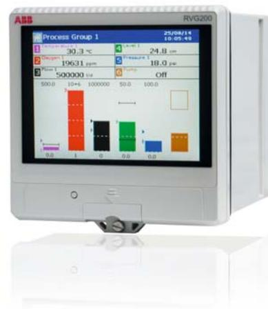
kritische Prozessmeldungen lassen sich mithilfe einer automatischen E-Mail-Benachrichtigung zu einem Bediener übertragen. Der RVG200 entspricht den Anforderungen der amerikanischen FDA-Vorschrift 21CFR Part 11 sowie den Anforderungen nach Schutzart IP66 und NEMA 4X (Schutz gegen starkes Strahlwasser).
