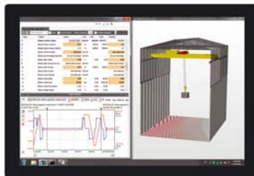
Mit der virtuellen Inbetriebnahme von ABB können Maschinenbauer und Systemintegratoren Antriebe und SPS simulieren und testen.
