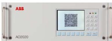
Ein dynamisch erzeugter QR-Code auf dem Gerätedisplay stellt System- und Diagnosedaten zur Verfügung.
