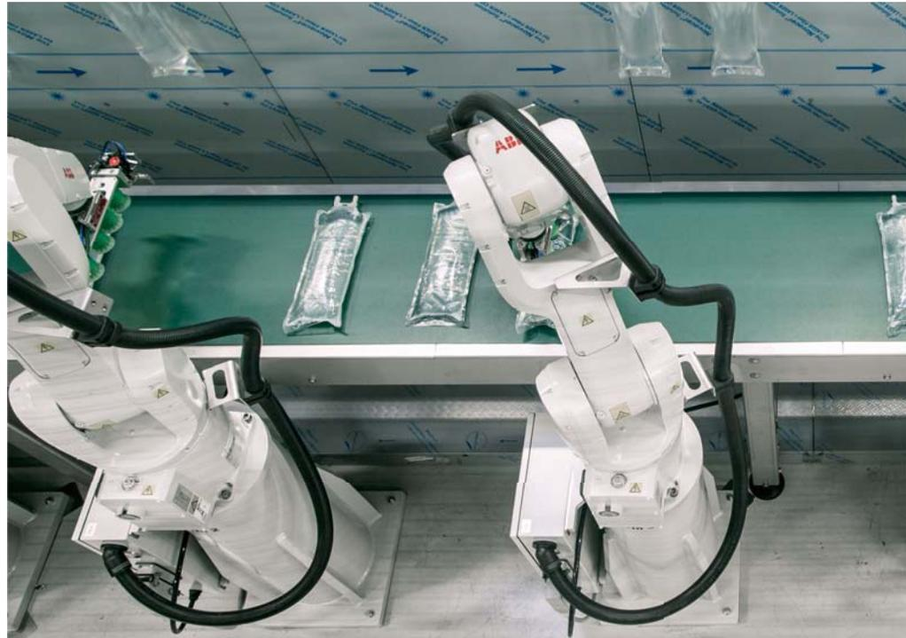
Leckprüfungsanlage von Wilco geführt werden. Drei weitere IRB 1200 legen sie nach erfolgter Prüfung wieder auf das Laufband. So können ganze 125 Beutel pro Minute – was einer enormen Gesamtkapazität von 15 000 Beuteln pro Stunde entspricht – der Leckprüfung zugeführt werden.
