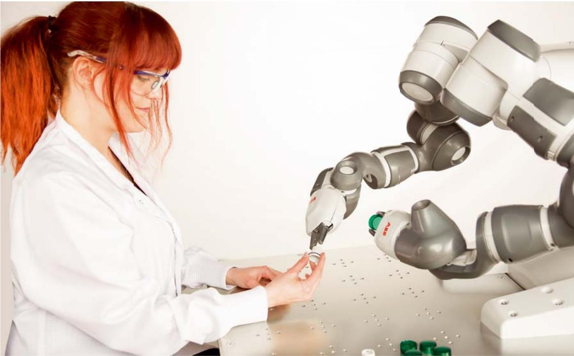
YuMi ist inhärent sicher: von weichen Materialien über Software zur Bewegungskontrolle bis hin zu einem Design, das alle Klemmstellen eliminiert – bei zwei Greifarmen mit je sieben Achsen eine beachtliche Leistung.
