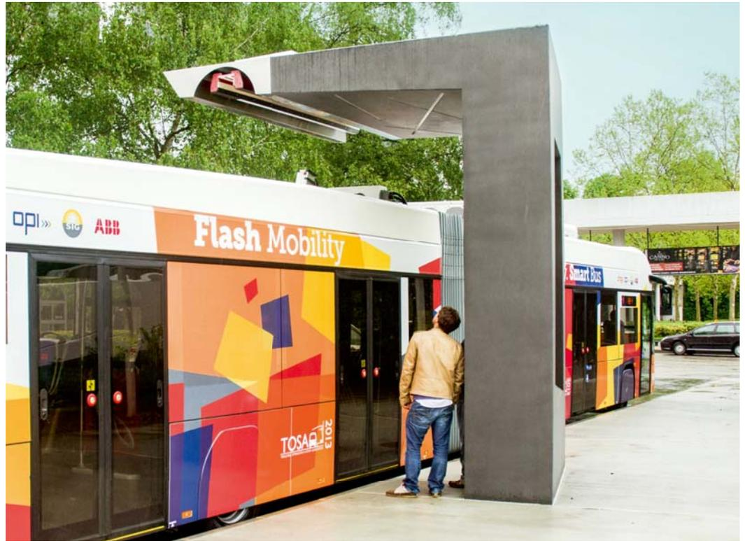
An den dafür ausgerüsteten Zwischenstationen wird der TOSA innert 15 s nachgeladen.
