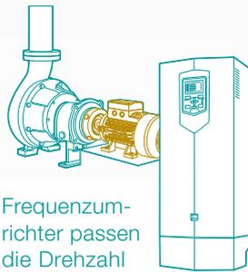
Frequenzumrichter passen die Drehzahl von Elektromotoren an den tatsächlichen Bedarf einer Maschine an, was den Energieverbrauch des Motors um 20 bis 50 % senkt. Besonders effizient funktioniert das mit der direkten Drehmomentregelung.
