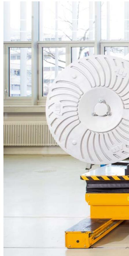
**E**s muss doch möglich sein, mehr aus diesen Dieselmotoren herauszuholen! Diese Herausforderung lässt den jungen ETH-Ingenieur und Sulzer-Angestellten Alfred Büchi nicht los. Er tüfelt so lange, bis er ein System entwickelt hat, das den Wirkungsgrad des Motors erhöht. Dazu nutzt er Abgas aus dem Motor. Er montiert Turbine und Verdichter – beides ursprünglich noch mehrfach – auf eine Welle und lässt 1905 diese «hochaufgeladene Verbundmaschine» für einen Diesel-Viertaktmotor patentieren.
