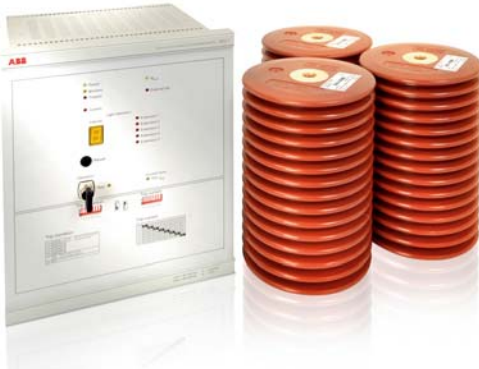
Der Ultraschnelle Erdungsschalter UFES ist aus einer elektronischen Einheit und den dazugehörigen Primärschaltelementen kombiniert. Im Fehlerfall stellt der UFES in weniger als vier ms eine 3-phasige Kurzschlusserdung her.
