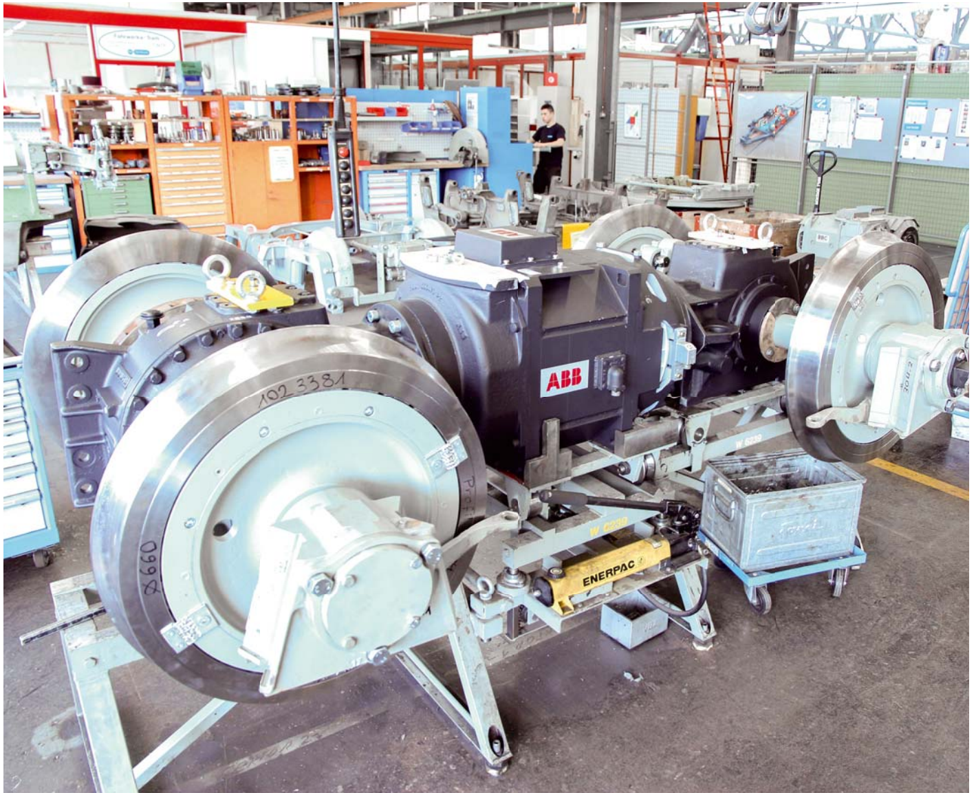
Ein von ABB neu konstruierter Motor wird in den VBZ-Werkstätten eingebaut.
