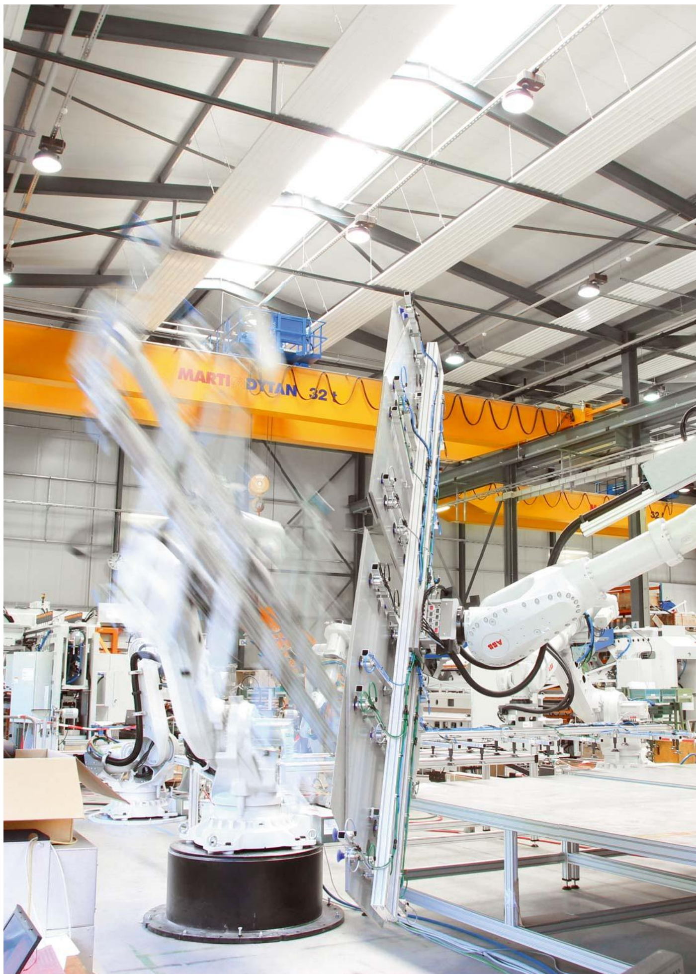
Dynamisches Zusammenspiel der insgesamt acht integrierten ABB-Roboter für die Platinenfertigung.
