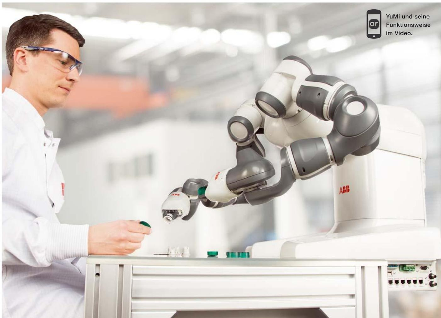
YuMi sieht durch sein präzises Visionssystem und fühlt durch seine empfindliche Sensorik. Sicherheit ist in der Funktionalität des Roboters integriert und ermöglicht eine gefahrlose Zusammenarbeit von Mensch und Roboter.
