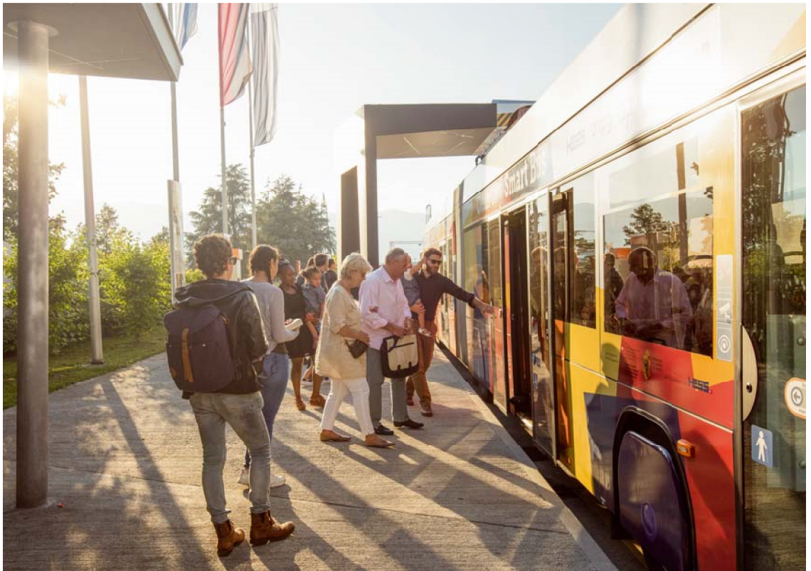
Während die Passagiere an der Haltestelle aus- und einsteigen, lädt das Flash-System die Busbatterie.
