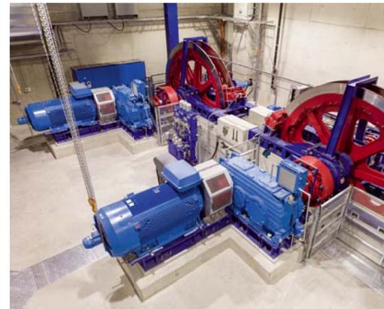
été construit par Garaventa AG, société suisse du groupe Doppelmayr/Garaventa, leader mondial de la construction de téléphériques. Deux cabines avancent à l'opposé l'une de l'autre sur le téléphérique, sur une construction à câble porteur qui les maintient dans les airs. Des câbles de traction actionnés par un moteur électrique assurent l'entraînement.
