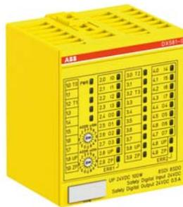
Afin d'optimiser la collaboration entre les individus et les robots, les commandes de robots d'ABB sont équipées d'E/S de sécurité supplémentaires.
