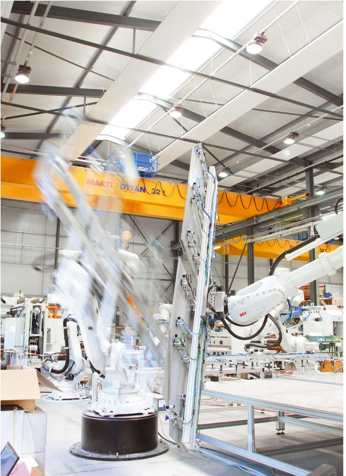
Interaction dynamique des huit robots ABB intégrés à la fabrication des flans.
