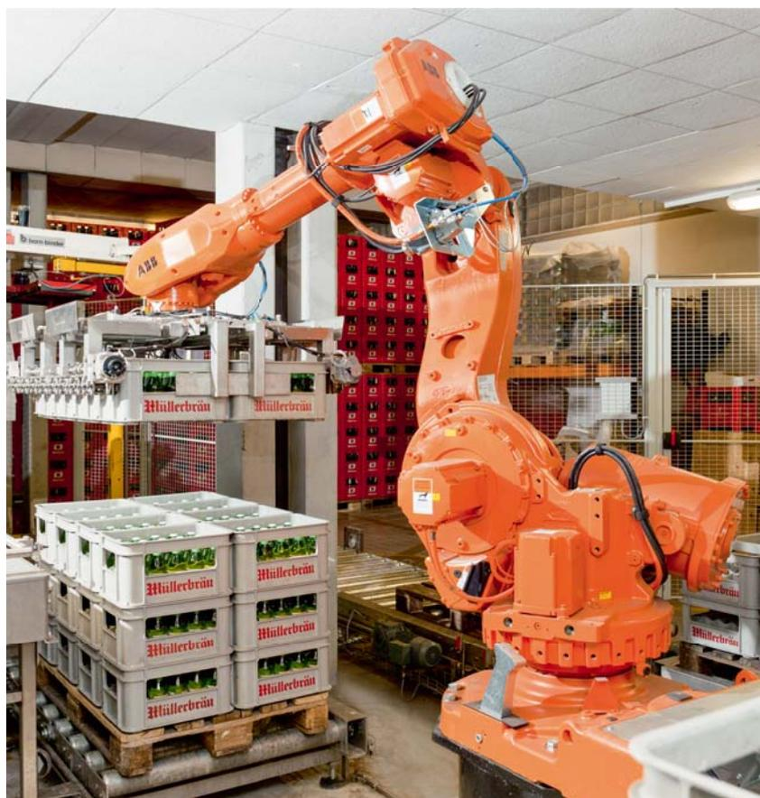
Un IRB 6600 à six axes d'ABB est utilisé chez Müller Bräu pour palettiser les caisses de bière.
