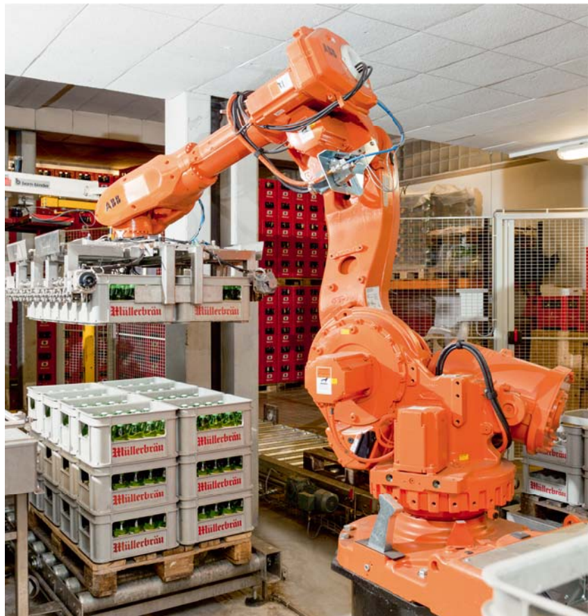
Bei Müller Bräu in Baden arbeitet ein 6-achsiger IRB 6600 von ABB als Palettierer für die Bierkisten.
