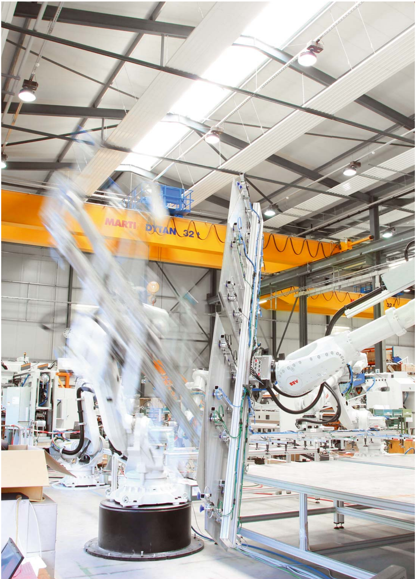
Dynamisches Zusammenspiel der insgesamt acht integrierten ABB-Roboter für die Platinenfertigung.
