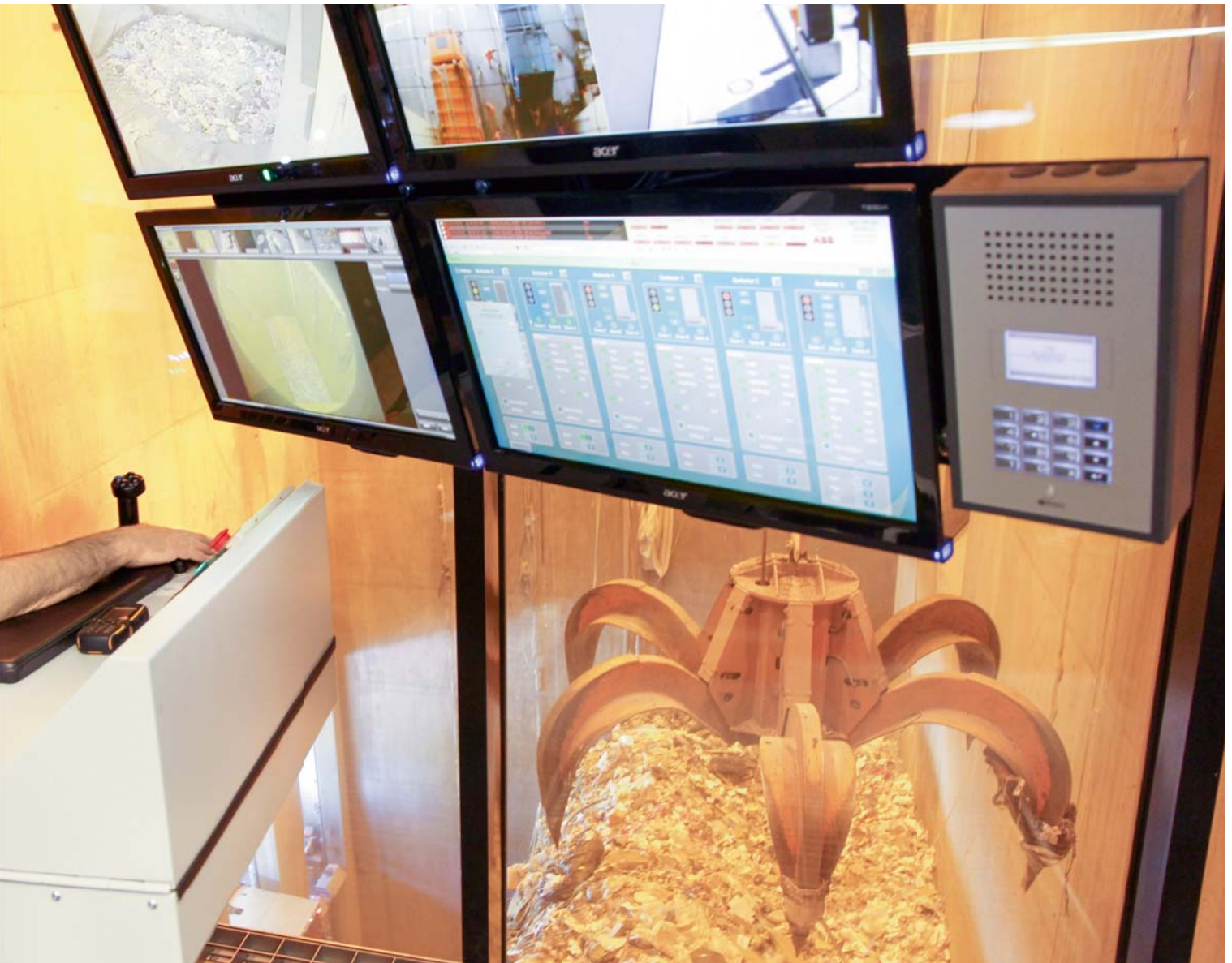
In der Kehrichtverbrennungsanlage der EZ Forsthaus werden täglich rund 350 t Abfall thermisch verwertet. Kranführer Dieter Faust beschickt den Ofen mit dem Brenngut.
